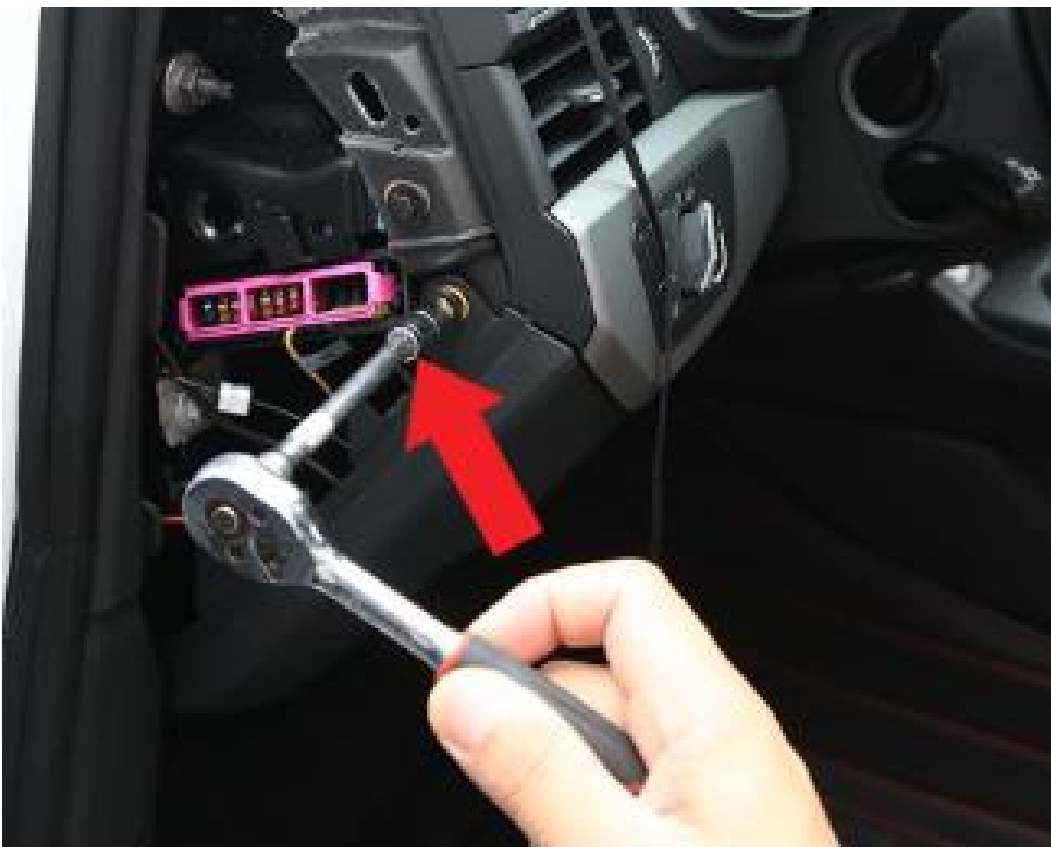
3. Unscrew the 8mm hex bolt.
